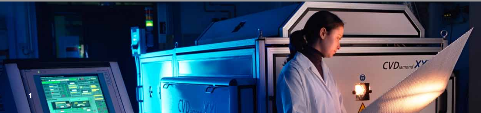
1 Heißdraht-CVD-Anlage zur großflächigen Beschichtung (bis 50 cm x 100 cm) von Elektroden mit leitfähigen Diamant.
